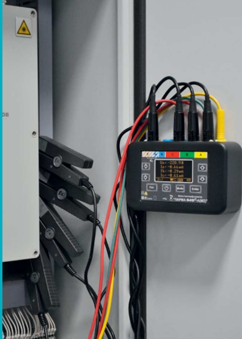
ДТИ-4 (от 3 до 1000 А) для измерения силы постоянного тока
